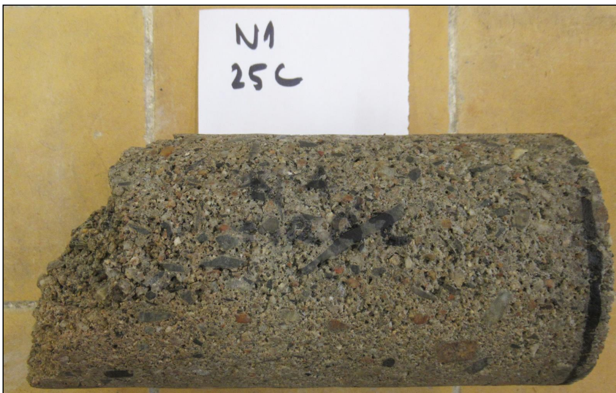
Foto 2: Vzorek N1 při zkoušce mrazuvzdornosti – 25 zatěžovacích cyklů Zaznamenán částečný rozpad zkušebního tělesa – hmotnostní úbytek 10,8 %. Vzhledem k porušení vnitřní struktury betonu během zkoušky nebylo již po 25 zatěžovacích cyklech možné stanovit dobu průchodu ultrazvukového impulzu.
