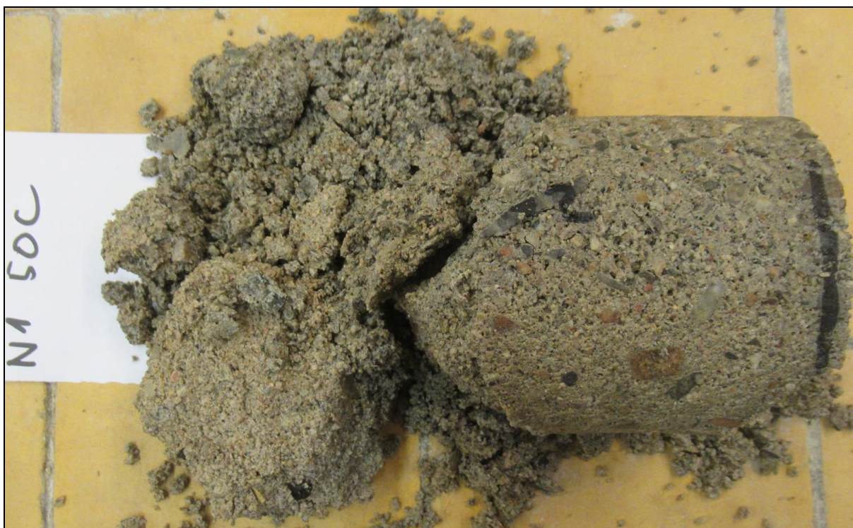
Foto 3: Vzorek N1 po zkoušce mrazuvzdornosti – 50 zatěžovacích cyklů Zaznamenán celkový rozpad zkušebního vzorku. Zkouška byla ukončena.
