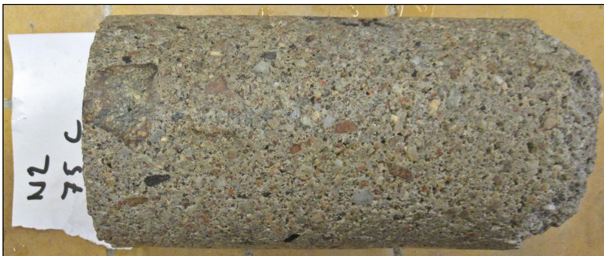
Foto 4: Vzorek N2 při zkoušce mrazuvzdornosti – 75 zatěžovacích cyklů Zaznamenán částečný rozpad zkušebního tělesa – hmotnostní úbytek dle ČSN 73 1322 = 3,1 %. Vzhledem k porušení vnitřní struktury betonu během zkoušky nebylo již po 75 zatěžovacích cyklech možné stanovit dobu průchodu ultrazvukového impulsu.
