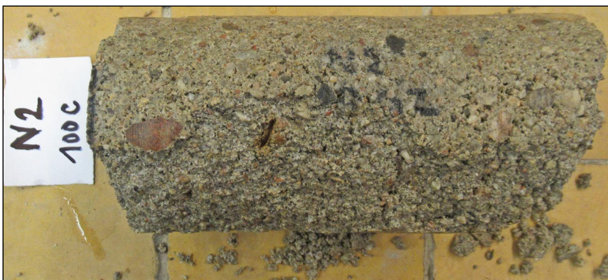
Foto 5: Vzorek N2 po zkoušce mrazuvzdornosti – 100 zatěžovacích cyklů Zaznamenán částečný rozpad zkušebního tělesa – hmotnostní úbytek dle ČSN 73 1322 = 10,5 %.
